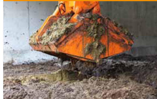
Es gibt keine Radlader auf der Anlage. Die ganze Mistverladung macht ein Kran.
